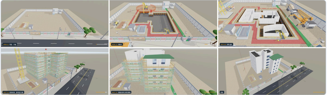
그림 6-1 · 공개 샘플을 날짜별로 — 착공 · 가설(2026.11) → 터파기(2026.12) → 지하 골조(2027.03) → 외부비계 · 방지망 전 층(2027.10) → 위에서부터 비계 해체(2027.12) → 준공
